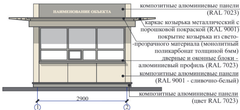
Фасад в осях 1-2
